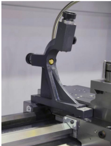
Mitlaufende Lünette mit Gleitbacken
