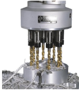
Vorbereitung für den Einsatz eines Mehrspindelbohrkopfes
