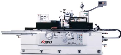
Die GU-35 A Rundscheifmaschine, gefertigt nach japanischen Normen, ermöglicht hochwertiges Rundscheifen kleiner Serien. Facharbeiter erreichen eine Wiederholgenauigkeit <1 µm dank präziser Komponenten und hydrodynamischer Schleifspindellagerung.
