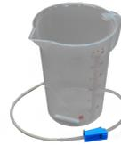
Suspensionsbehälter mit Quetschvorrichtung
