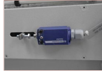
Sägebandbruchüberwachung Maschinenstopp bei Bandbruch
