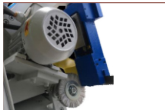
Motorisch angetriebene Spänebürste Effektives Reinigen des Sägebandes vor dem Einlaufen in die Antriebsrolle, nachstellbar - Inklusive -
