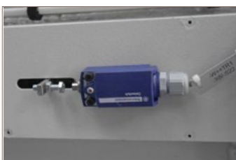
Sägebandbruchüberwachung Maschinenstopp bei Bandbruch
