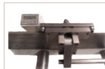
Längenanschläge für Rollenbahnen, manuell klemmbar und abschwenkbar mit Massband oder Digitalanzeige
