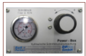
Power-Box Comfort Hydraulische Schnittdrucküberwachung Bedienung vom Bedienpult, Schnittdruck ablesbar über Manometer mit Eilgangfunktion
