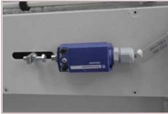
Sägebandbruchüberwachung Maschinenstopp bei Bandbruch
